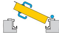
**DEFINIZIONE MISURA PORTA DA SEZIONE LONGITUDINALE**
