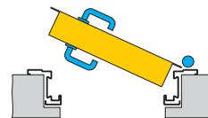
**DEFINIZIONE MISURA PORTA DA SEZIONE LONGITUDINALE**
