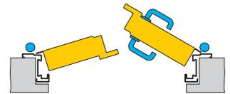
**DEFINIZIONE MISURA PORTA DA SEZIONE LONGITUDINALE**
