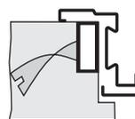
CONTROTELAIO A MURARE SU TELAIO AD AVVITARE
