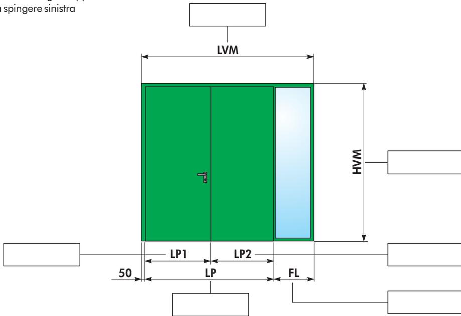
COD. VTb con telaio tubolare a "L"
