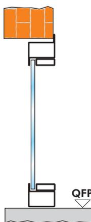
COD. **VTa** con telaio tubolare a "L"
