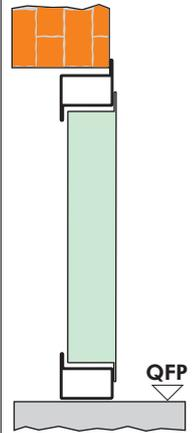
COD. **VTb** con telaio tubolare a "L"
