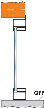
COD. VTa con telaio tubolare a "L"
