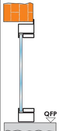
COD. VTb con telaio tubolare a "L"
