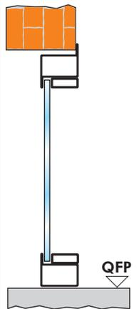
COD. VTb con telaio tubolare a "L"
