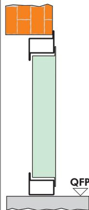
COD. **VTa** con telaio tubolare a "L"
