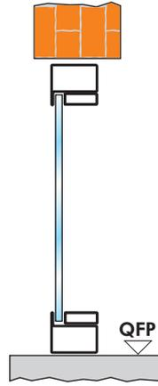
COD. VTb con telaio tubolare a "Z"
